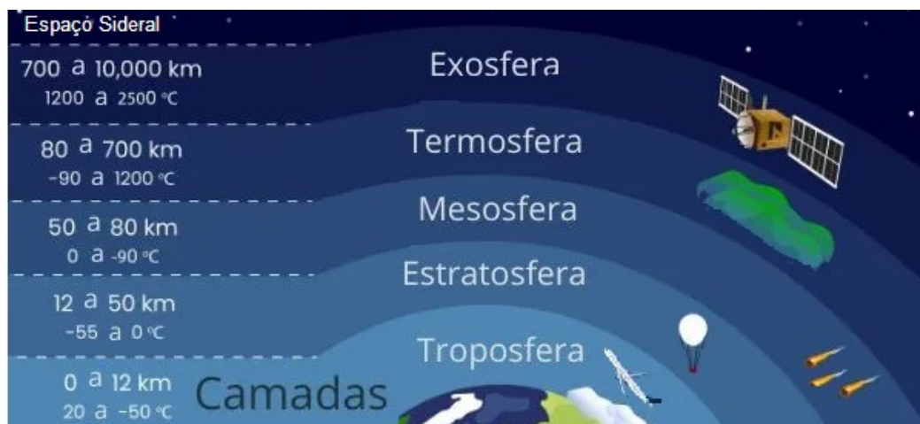
Figura 3 As ondas em radiofrequência atravessam diversas camadas até ao satélite [47]
