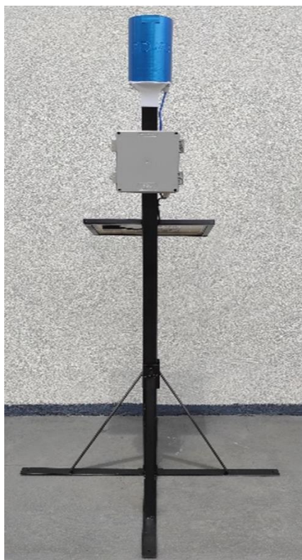
Figura 9 – Montagem completa do pluviômetro automatizado
