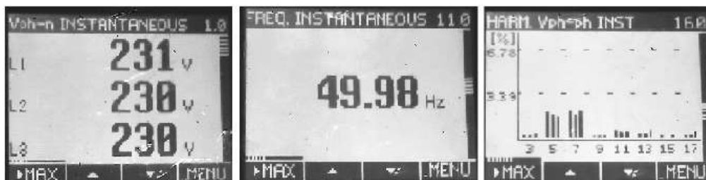
Figura 7 - Medições: Tensões trifásicas instantâneas fase- neutro, Frequência instantânea e Percentagem de harmônicas nas 3 fases (PAC 4200)
