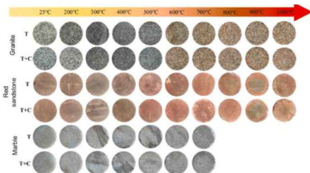
Figura 2 Variação da cor na superfície e grau de dano nos três tipos de rochas.
