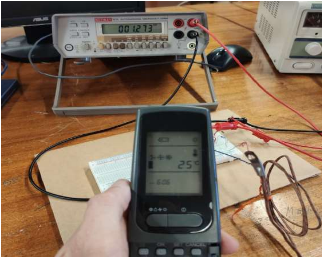
Figura 5 - Medição da temperatura ambiente com o termopar tipo J.
