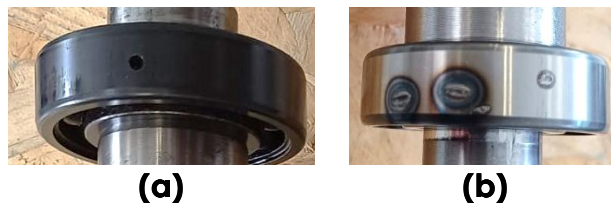
Figura 3 – Rolamentos com avarias: (a) Furo de Ø2 mm na pista exterior do rolamento SKF6206-2Z; (b) ED no rolamento SKF6205-2Z
